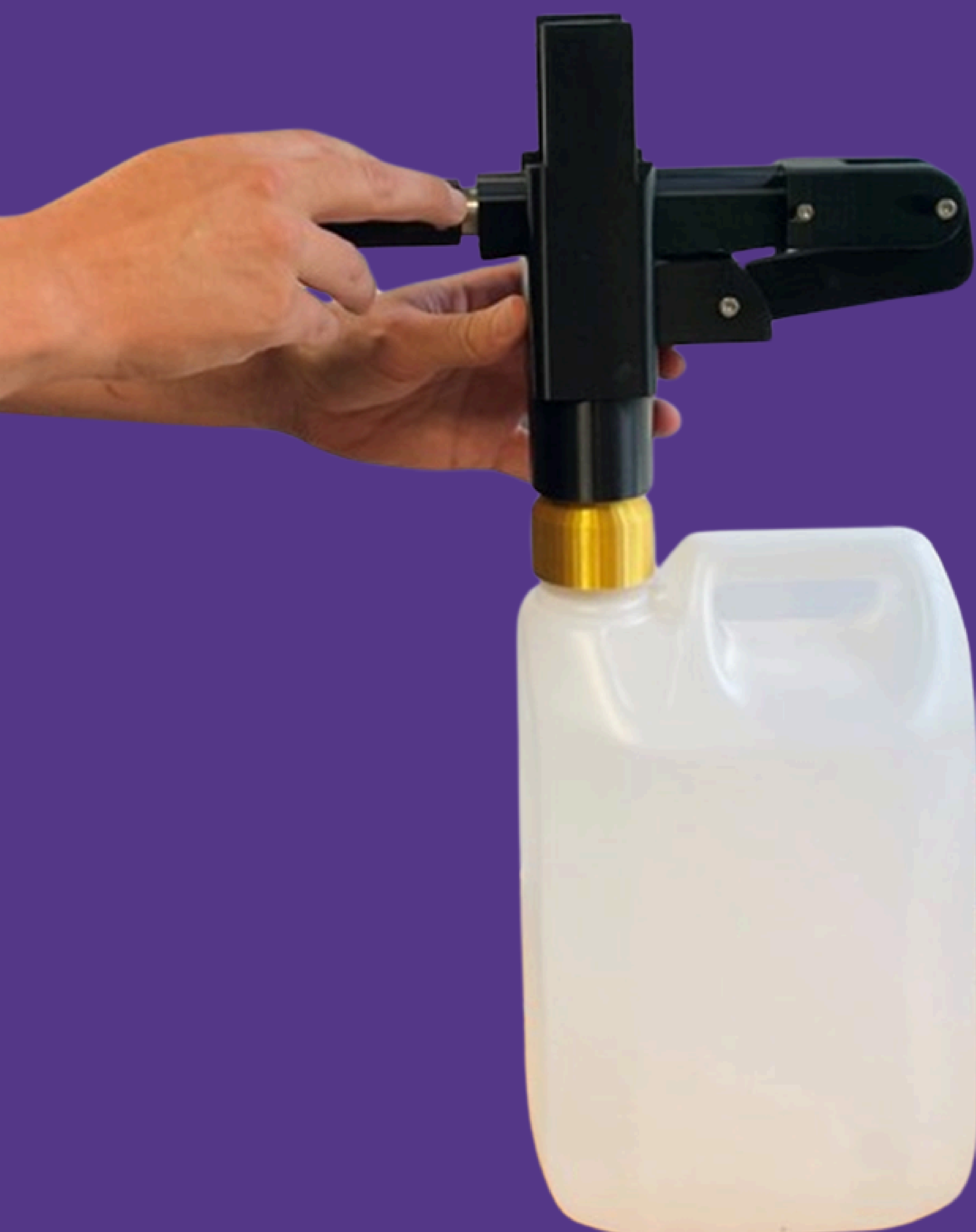
Figur 5. Eksempel på sprøjtetømningsstation. En sprøjte tømmes for resterende væske i en opsamlingsbeholder, så medicin og plast kan bortskaffes hver for sig.
