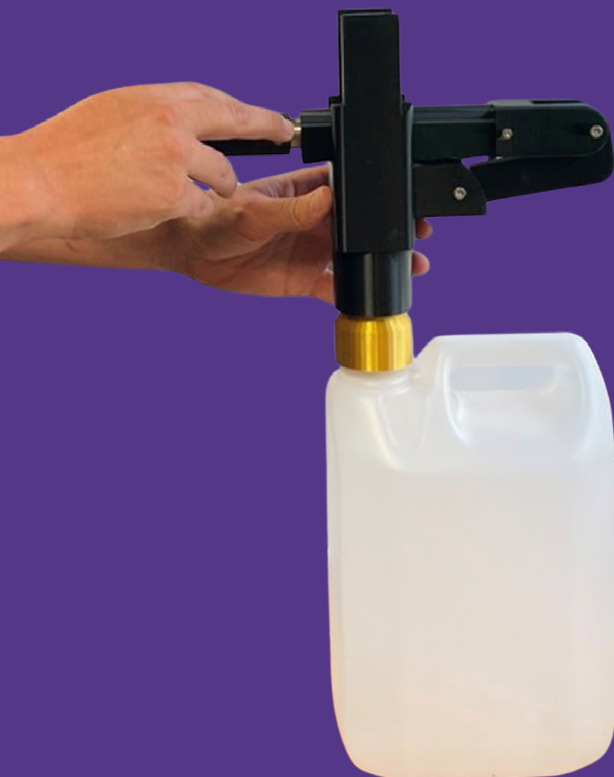
Figur 5. Eksempel på sprøjtetømningstation. En sprøjte tømmes for resterende væske i en opsamlingsbeholder, så medicin og plast kan bortskaffes hver for sig.
